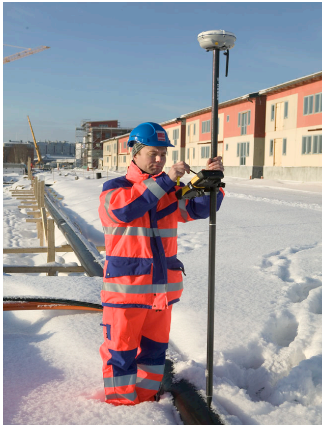
Figur 7.12. Utrustning vid mätning med nätverks-RTK. Foto: Lantmäteriet.
