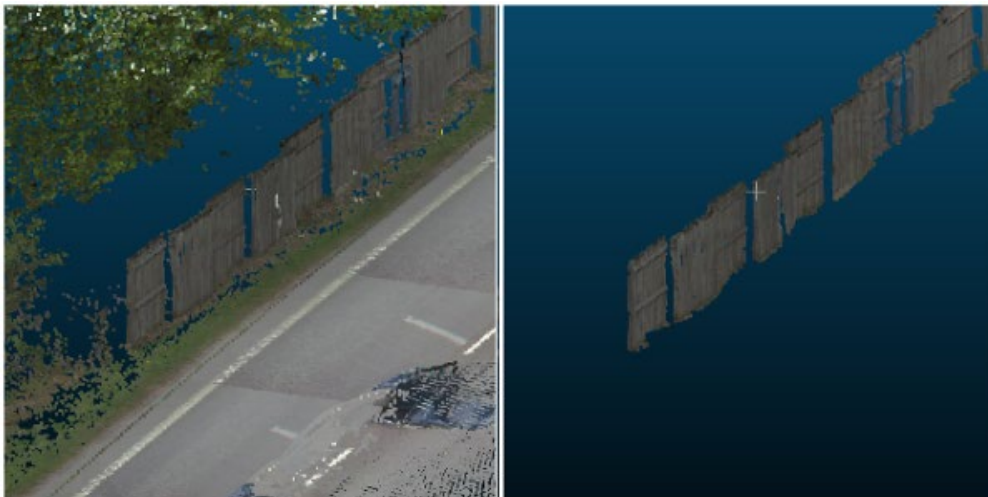
Figur 1.4. Insamling av geografisk information med hjälp av laserskanning. Till vänster är ett punktmoln där punkterna har klassificerats automatiskt. Till höger är ett bullerplank som extraherats ur punktmolnet. Källa: Gustaf Ugglå, KTH.
