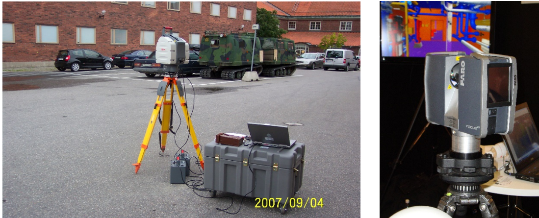
Figur 15.15. Till vänster: pulsad laserskanner Leica Scan Station med tillhörande bärbar dator, batterier och transportlåda. Till höger: fasskillnadsbaserad laserskanner FARO Focus 3D med inbyggt batteri och pekskärm. Jämför även storleken på skannrarna (du kan använda trefötter som referens) (fotograf: Yuriy Reschetiuk).
