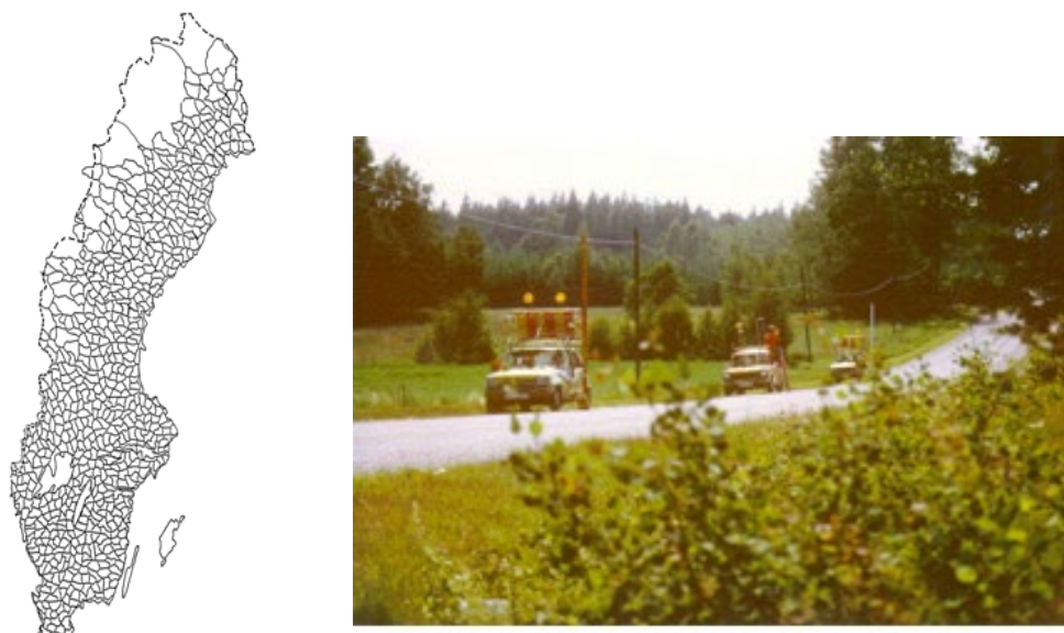
Figur 4.9. (Vänster) Slingor som används vid tredje riksavvägningen. (Höger) Motoriserad avvägning. Källa: Lantmäteriet.
