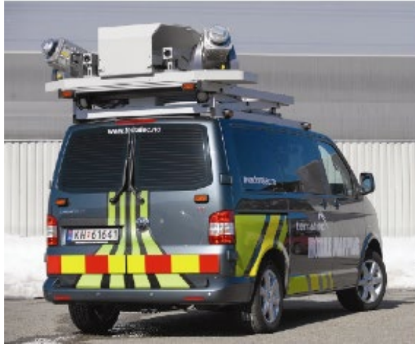
Figur 14.15. Fordonsburet integrerat sensorsystem (Lynx) med kameror, laserskannrar och ett integrerat navigationssystem (Terratec)
