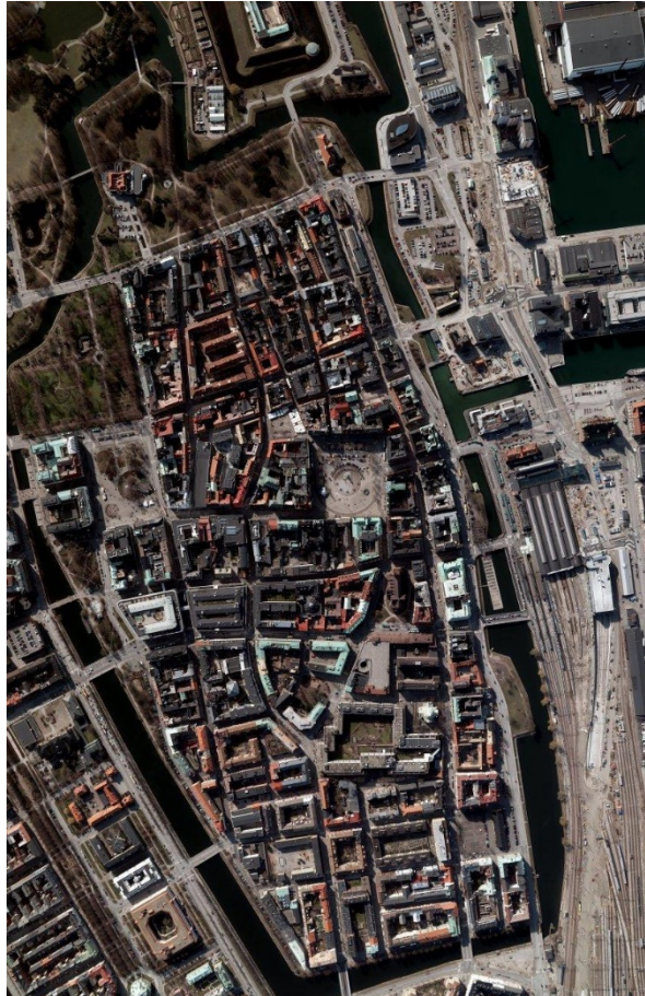
Figur 12.2. En flygbild över Malmö registrerad med digital flygmätkamera Vexcel Xp. Originalformat 104 x 69 mm. (Bild Blom Sweden AB. Godkänd för spridning)
