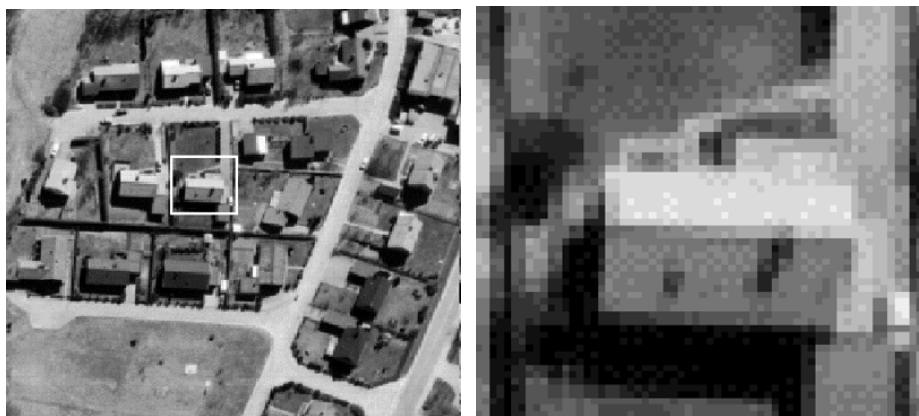
Figur 12.5. En digital bild och dess uppbyggnad av bildelement (pixlar).
