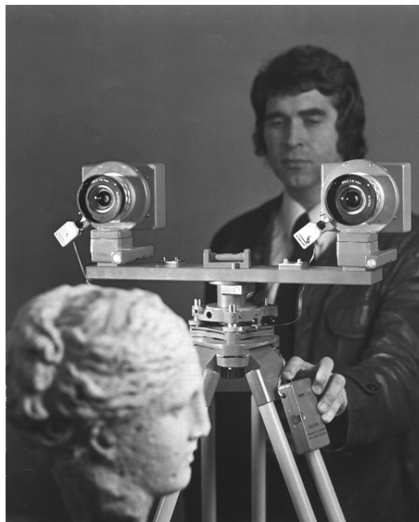
Figur 14.12. Stereokamera med fast bas (Leica /Wild P32), och exempel på uppmätt skulptur (KTH Fotogrammetri).
