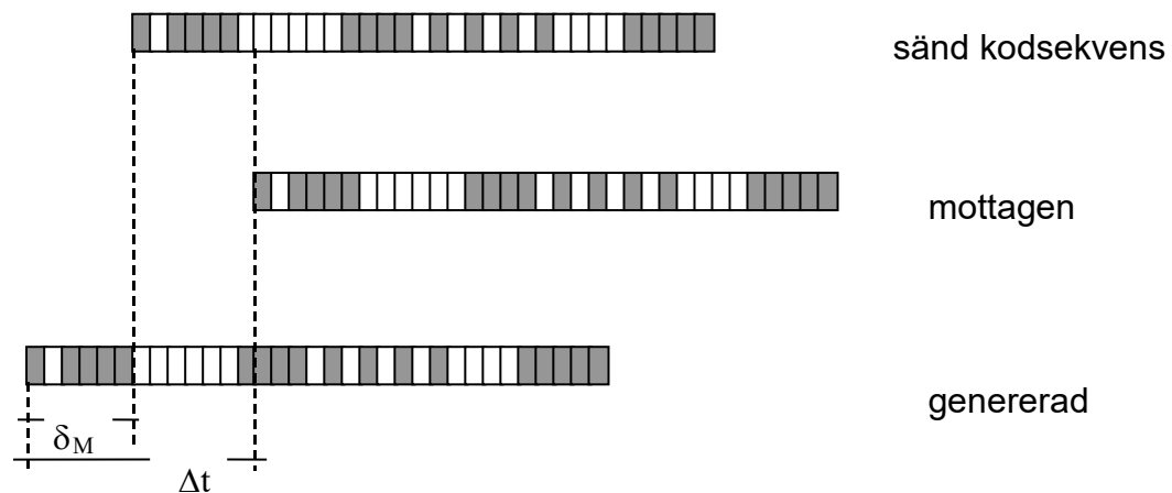
Figur 10.4. Kodmätning. Mottagaren förskjuter genererad signal tills den matchar (korrelerar) mottagen signal. Längden av förskjutningen motsvarar signalens gångtid ( \Delta t ). \delta_M betecknar mottagarens klockfel, vilket direkt påverkar bestämning av \Delta t . Satellitens klockfel är mycket mindre, därför visas det inte i figuren.
